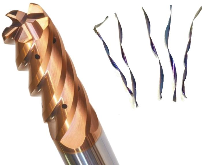
I due fori di lubrificazione per ogni tagliente assicurano una corretta e omogenea refrigerazione in ogni parte del pezzo tenendo il truciolo lontano dalla zona di taglio
