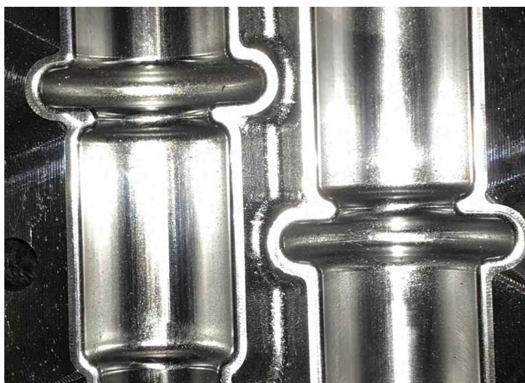
La fresa d.4 è stata usata per effettuare le riprese , le aperture delle flange .
