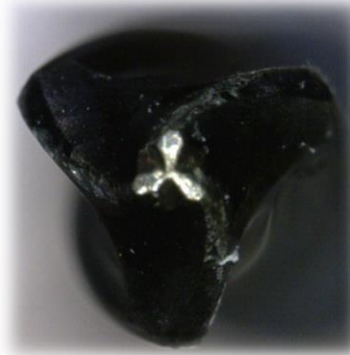
Dopo 150 fori con emulsione 8%
