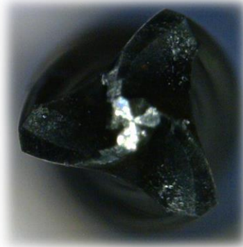
Dopo 80 fori con emulsione 8%
