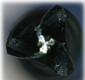
Dopo 80 fori con emulsione 8%
