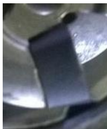
Usura inserto dopo 240 minuti di lavoro
