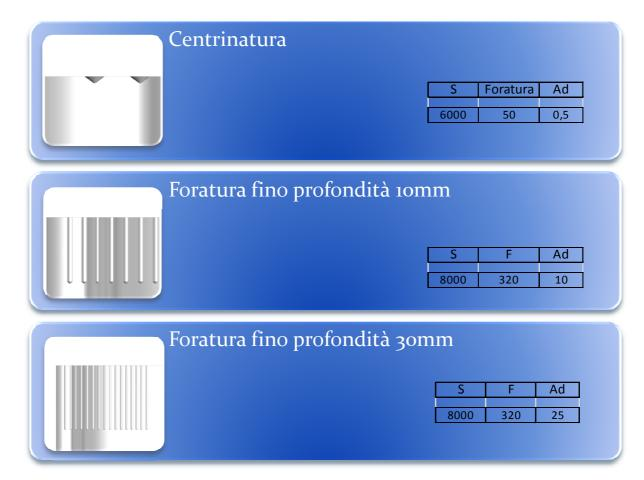
Note: si consiglia una lubrificazione con olio in percentuale superiore al 10% e la riduzione della velocità di rapido in entrata e uscita dal foro nella fase di scarico trucioli.
