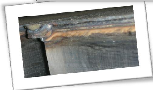
Sul bordo esterno e interno e' presente un cordone di saldatura in stellite , le frese lavorano sempre su una parte di C40 e stellite .
