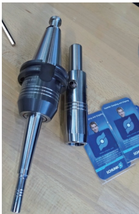
Il mandrino universale TENDO EC della Schunk.
