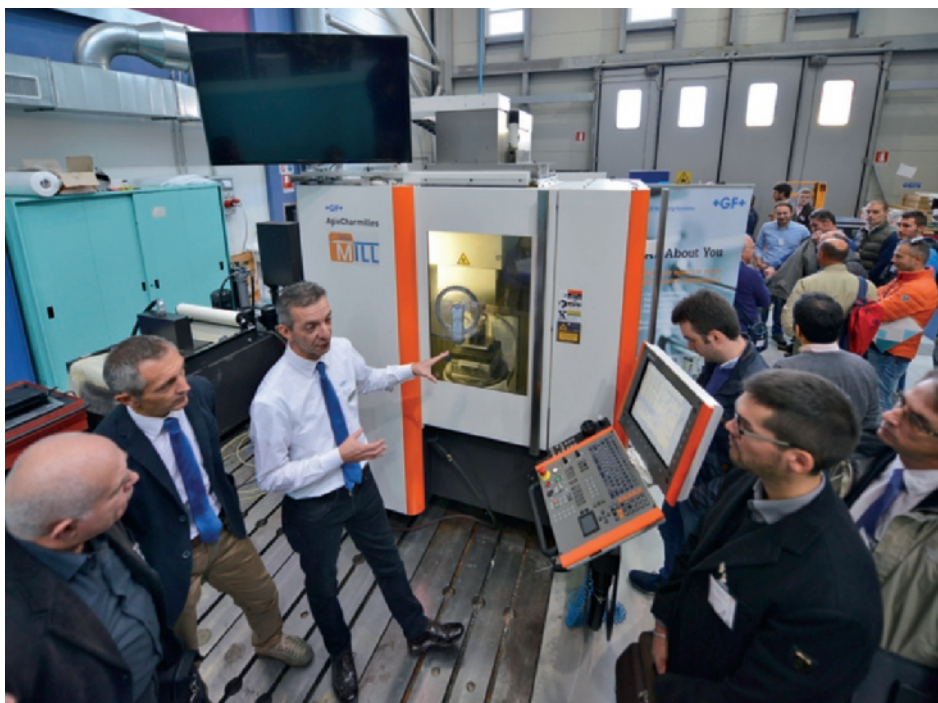
Il centro di lavoro a 5 assi MIKRON HPM 450U di GF Machining Solutions su cui è stata eseguita la lavorazione.
